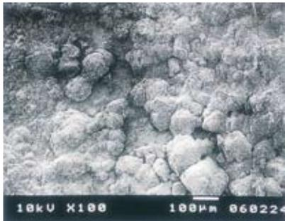
使用贝斯通混合材形成致密的颗粒物(硅酸钙)将隙缝填满和封闭
